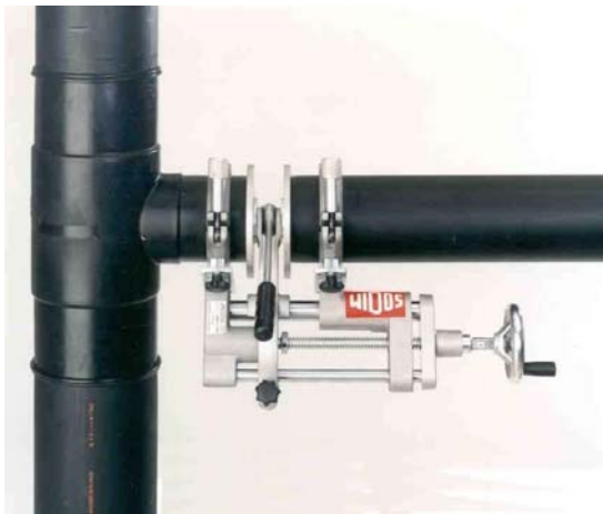
Einsatz der Maschine direkt im Rohrnetz
