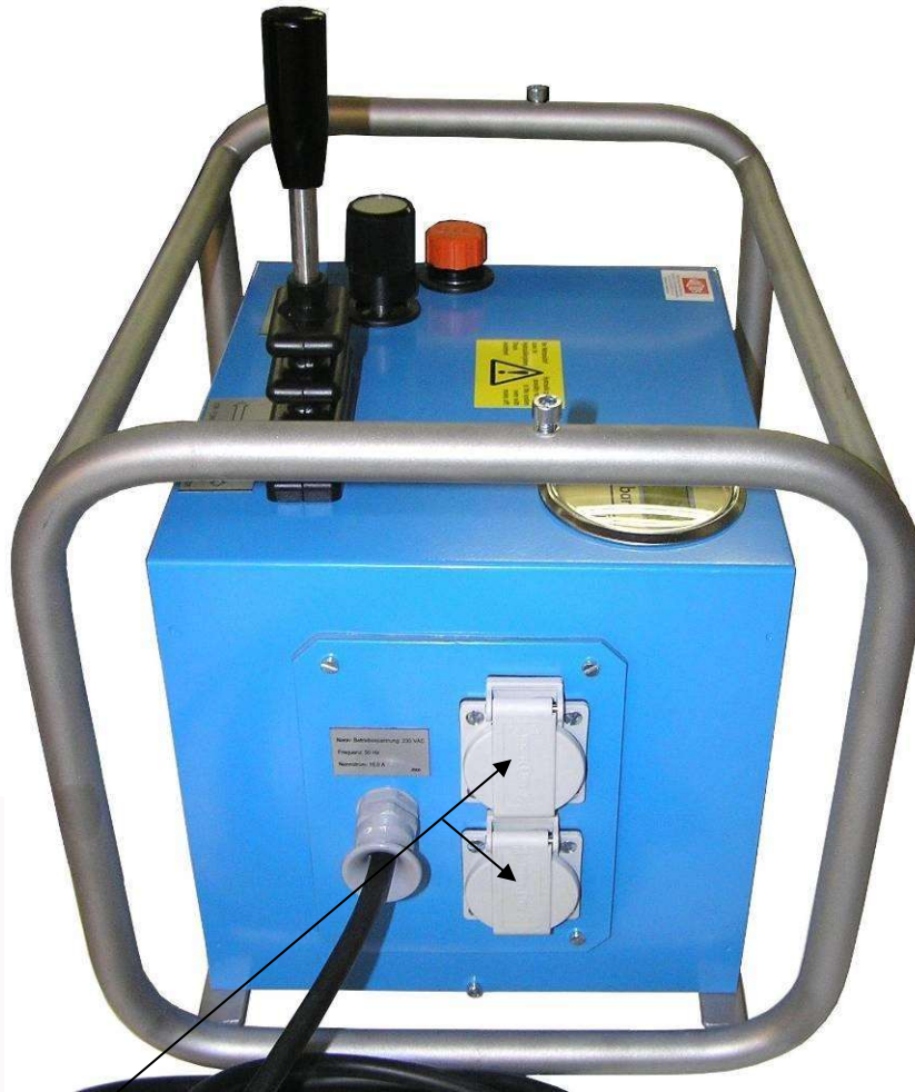
Steckdosen komplett Hydraulikaggregat EST0701
