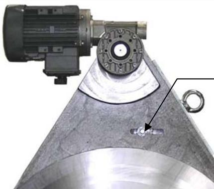
Schraube zum Spannen der Antriebskette. (Dazu den Planhobel auf der Rückseite öffnen.)
