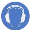
Der Geräuschpegel der Maschine liegt über 80 dB (A). Die genauen Werte, die im Arbeitsverlauf entsteht, können Sie auf Seite 11 nachlesen (Kap. **Fehler! Verweisquelle konnte nicht gefunden werden.**).
