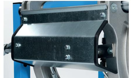
*Schutz der Hydraulikschläuche*
