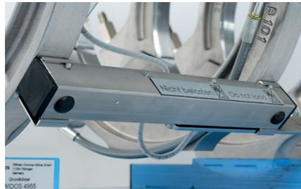
*Verlagertes Wegmesssystem am Grundspannwerkzeug*
