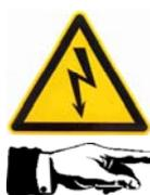
Alle Wartungs- und Instandsetzungsarbeiten sind grundsätzlich bei abgeschalteter Maschine durchzuführen. Dabei ist die Maschine gegen unbeabsichtigtes Einschalten zu sichern.
