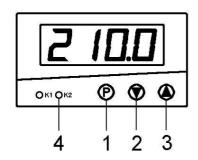
Die Taste P (1) kurz betätigen, auf dem Display erscheint <SP>, mit den Tasten ▼ (2) / ▲ (3) den Sollwert ändern. Die Taste P (1) kurz betätigen, die Isttemperatur erscheint wieder (oder nach 30 s automatische Änderung).
