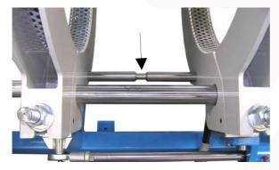
Zwischen den beweglichen und festen Spannringen der Grundmaschine ist ein Abreißstab montiert. Er verhindert das Festkleben des Heizelementes an den aufgeheizten Rohrenden.
