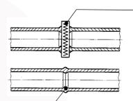
Heizelement erhitzt die Rohre auf Schweißtemperatur
