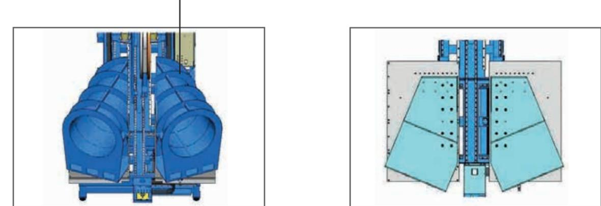
1. Schweißung beim Herstellen eines T-Stückes 45° | 1st welding for producing a T-piece 45°
