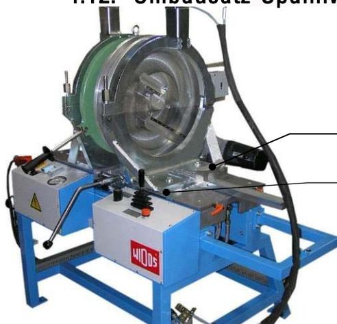
Schrauben Sie die Umbausatz- Spannwerkzeuge auf die Maschinentische fest mit den Sechskantschrauben.
