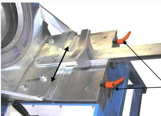
Zum Ausrichten der Rohre kann das rechte Spannwerkzeug horizontal verschoben werden. Lösen Sie hierzu die beiden Klemmhebel, verschieben Sie nun das Spannwerkzeug in Pfeilrichtung bis die Rohre keinen Versatz mehr haben. Sichern Sie diese Position durch das Festziehen der beiden Klemmhebel.
