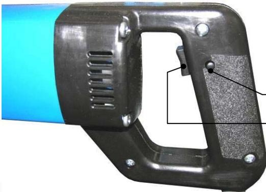
Der Planhobel muss für den Hobelvorgang immer bereit geschaltet sein. Drücken Sie dazu den Taster am Hobelmotor und sichern Sie das Einschalten mit dem Halteknopf.
