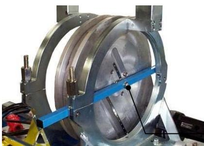
Muss auf einer Seite weniger gehobelt werden (z.B. bei einem Fitting) kommt der Balken zum einseitigen Hobeln (A) zum Einsatz.
