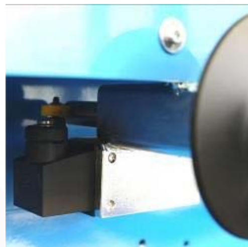
Sicherheitsschalter betätigt (durch Heizelementgriff)
