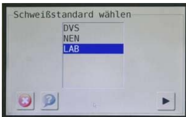
Anzeige: Schweißstandard-Möglichkeiten, der ausgesuchte Schweißstandard wird markiert.
