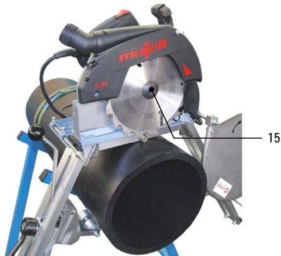
Lösen Sie mit dem beigelegten Inbusschlüssel SW 5, die Schraube (15) des Sägeblatts.
