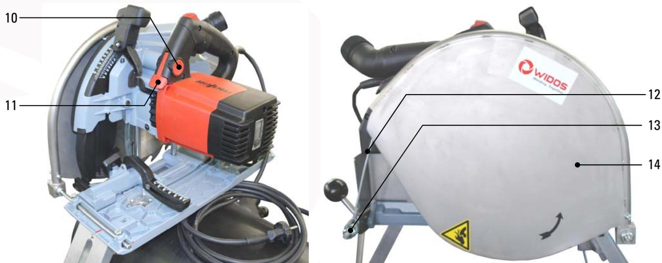
Betätigen Sie den Druckknopf (10) und klappen Sie den Hebel (11) nach oben.
