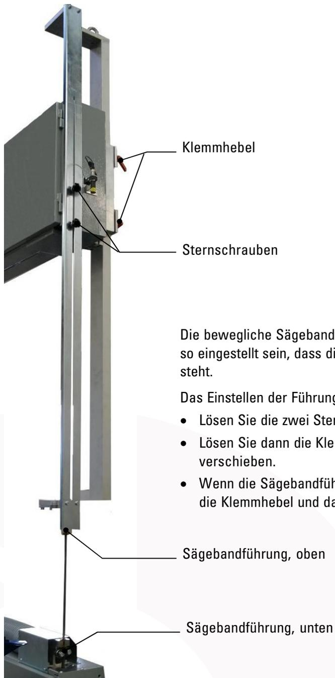
Die bewegliche Sägebandführung oben, sollte beim Sägevorgang in der Höhe so eingestellt sein, dass die Unterkante etwas oberhalb dem zu sägenden Rohr steht.
