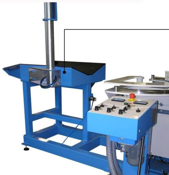
Foto zeigt linke Rohrauflage um 180° versetzt montiert (für Sägeradien größer 285 mm)
