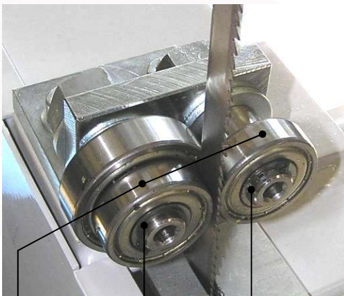
Sicherungsringe Laufrollen (hier ohne große Fase)
