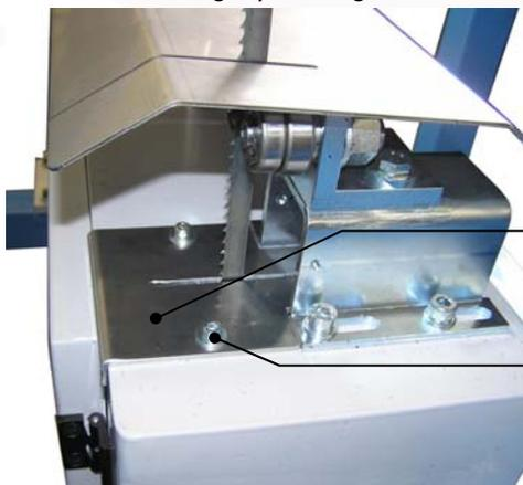
Entfernen Sie die Zylinderschrauben und entnehmen Sie das Schutzblech.
