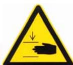
Dieses Symbol bedeutet eine mögliche Verletzungsgefahr durch Klemmen.
