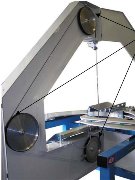
Öffnen Sie den Sägebügel und entnehmen Sie das Sägeband nach vorn.
