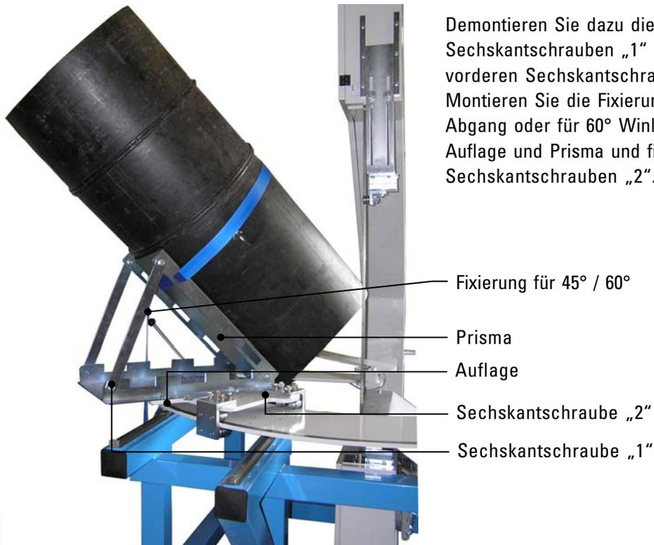
Demontieren Sie dazu die hinteren zwei Sechskantschrauben „1“ und lösen Sie die vorderen Sechskantschrauben „2“. Montieren Sie die Fixierungen für 45° Winkel-Abgang oder für 60° Winkel-Abgang zwischen Auflage und Prisma und fixieren Sie die Sechskantschrauben „2“.
